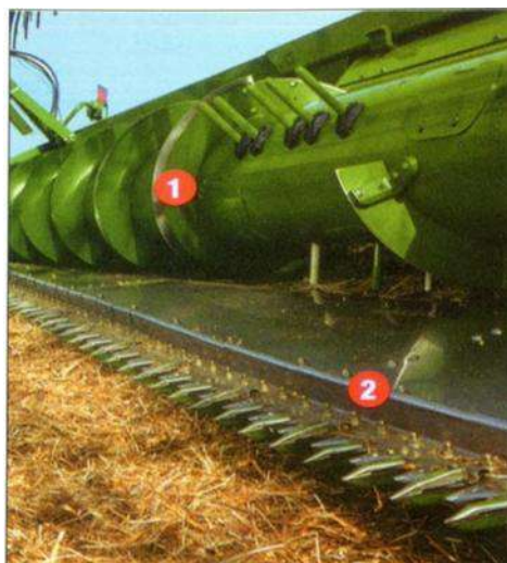
Рис. 5. Шнек жатки JohnDeere 625F з гнучким різальним апаратом: 1 – шнек жатки; 2 – гнучкий різальний апарат.
