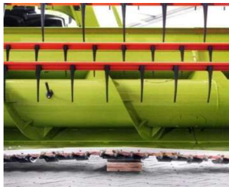
Рис. 8. Жатки MAXFLEX і FLEX оснащені гнучким різальним апаратом: а – гнучкий різальний апарат жатки MAXFLEXS750;
