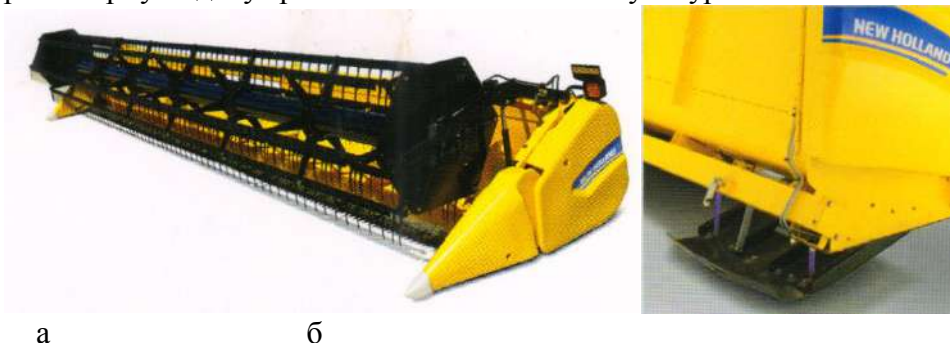
Рис. 2. Жатка Super Flex (а) і автоматичне регулювання висоти жатки (б).
