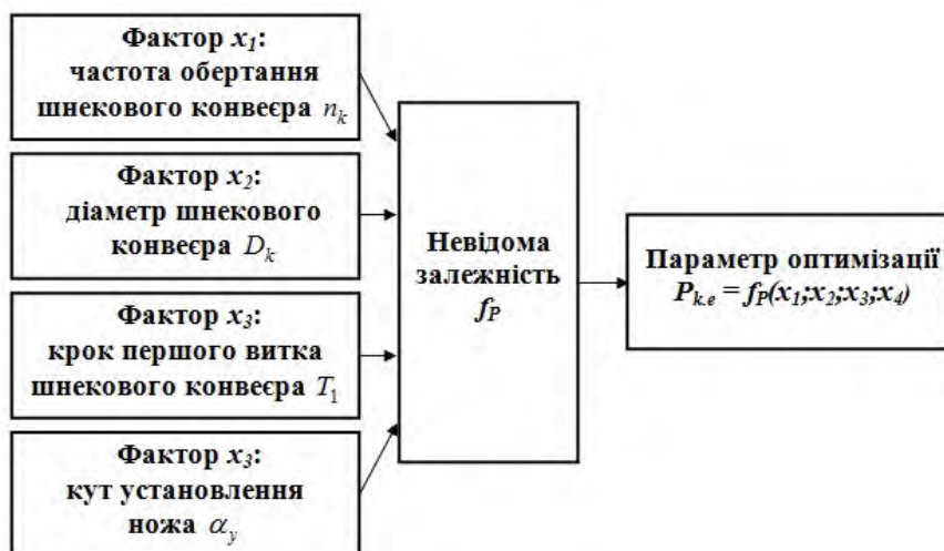
Рис. 2. Структурна схема моделі планованого експерименту типу ПФЕ 3 4 .
