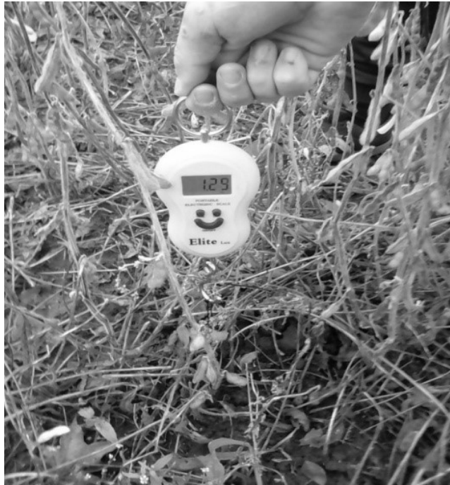
Рис. 7. Дослідження зусиль висмикування стебла з ґрунту.
