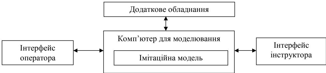
Рисунок – Структура комп'ютерного тренажера
