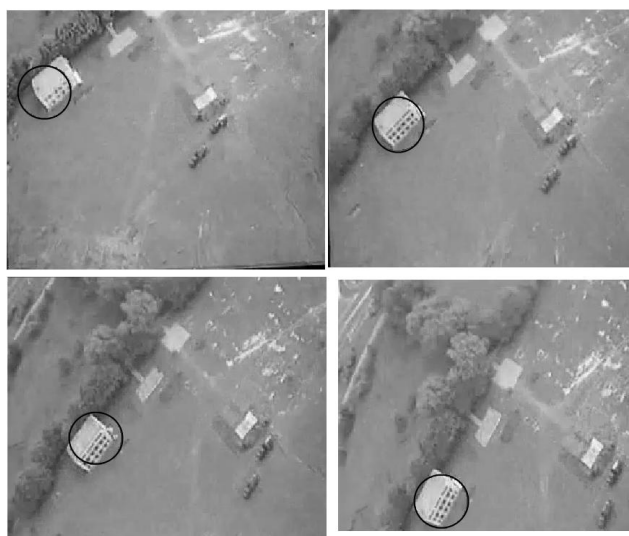
Рис. 3. Результати реалізації програмою Video Object Tracking процедури ведення цілі
