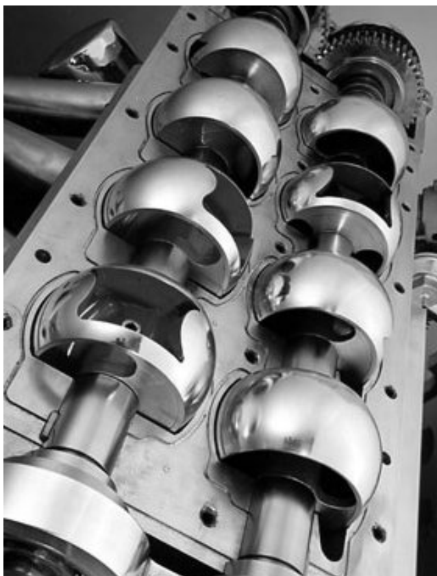
Rys.6. Głowica 4-suwowego 4 cylindrowego rzędownego silnika ZI ze sferycznymi zaworami obrotowymi firmy Coates [8]
