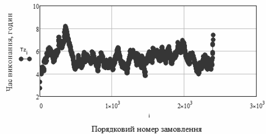
Рис.3. Сукупний час виконання кожного замовлення в ПАС при 4 менеджерах складу запчастин з продуктивністю 20,5 комплектів запчастин за зміну ( \psi=0,976 )
