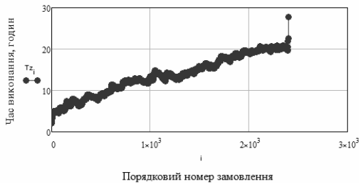
Рис.2. Сукупний час виконання кожного замовлення в ПАС при 4 менеджерах складу запчастин з продуктивністю 19 комплектів запчастин за зміну ( \psi=1,053 )
