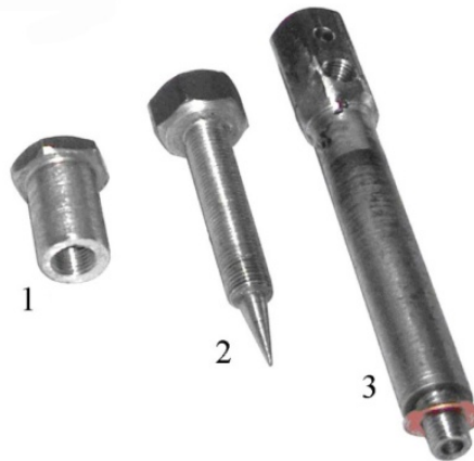
Рис. 3. Загальний вигляд деталей дросельного пристрою: 1 – контргайка; 2 – регулювальна голка; 3 – корпус дроселя.
