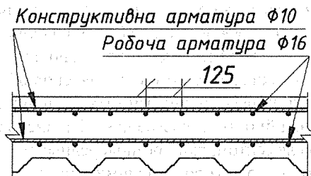
Рис. 2. Поздовжній переріз плити проїзної частини
