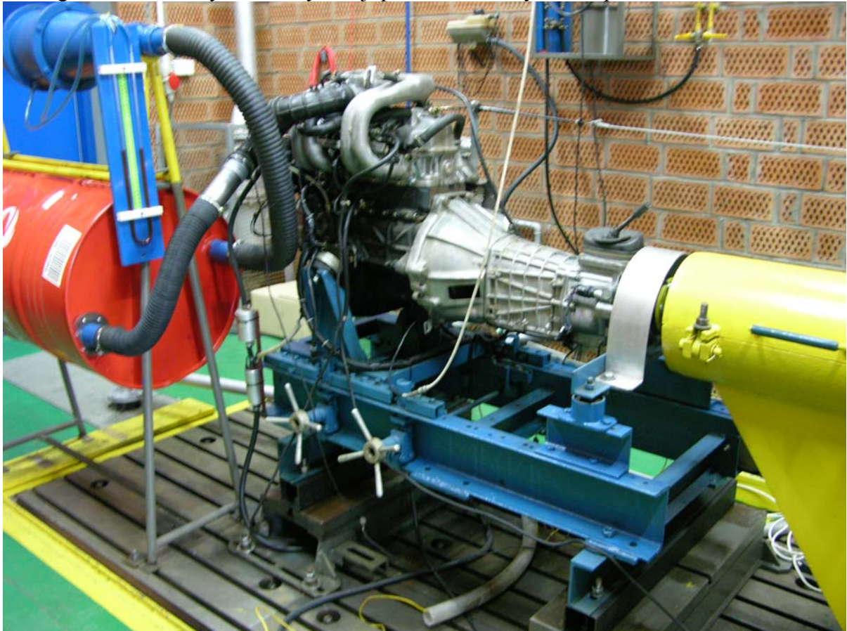
Rys. 1. Widok stanowiska silnika 1.6 MPI do badania wpływu modyfikacji parametrów wtrysku i zapłonu na emisję składników toksycznych w czasie zimnego rozruchu silnika o ZI
