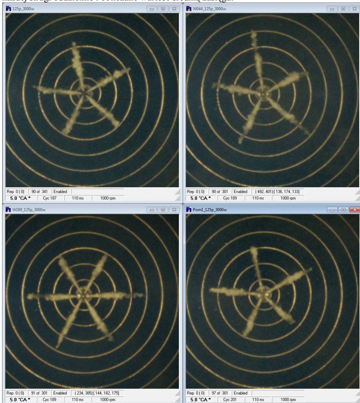
Rys. 3. Widok strug paliwa sfotografowany po 5° obrotu wałka pompy od rzeczywistego początku wtrysku dla czterech badanych wtryskiwaczy ( t_{wtr}=3 ms, p_{raii}=125 MPa, n=1000 obr/min)
