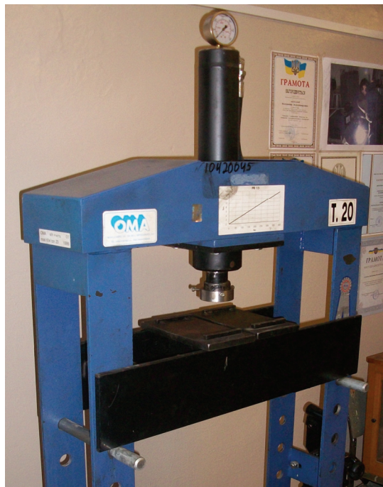
Рис 1. Гідравлічний прес зусиллям 200 кН для проведення лінійного індентування
