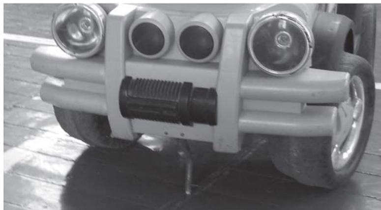
Рис. 3. Траєкторієвідмітчик встановлений на тягачі.
