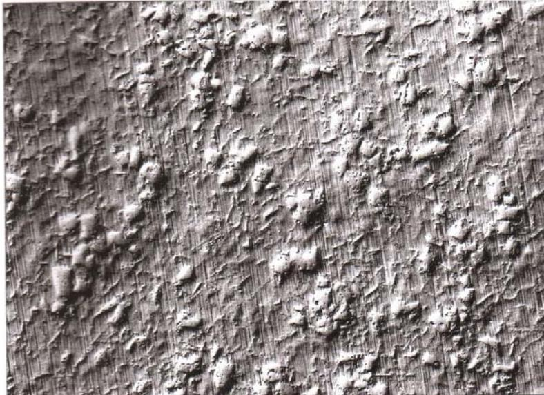
Рис. 2. Мікрофотографія робочої поверхні циліндра із заевтектичного алюмінієво-кремнієвого сплаву
