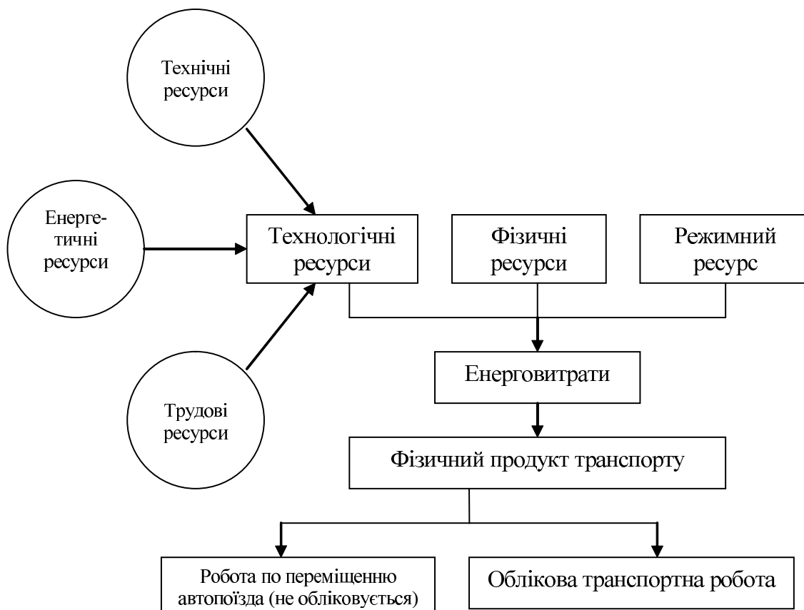
Рис. 1. Енергетична схема перетворення ресурсів у перевізному процесі
