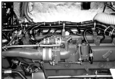
Rys. 2. Widok silnika gazowego IVECO o pojemności 9,5 dm 3 z wielopunktowym wtryskiem gazu [2]
