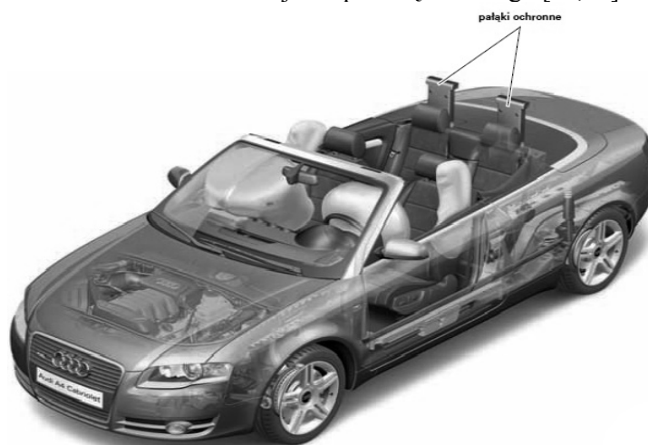
Rys. 11. Wysuwane pałaki ochronne w pojazdach z nadwoziem otwartym Audi [3]
