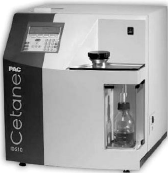
Rys. 3. Aparat do oznaczania pochodnej liczby cetanowej CID 510 firmy Walter Herzog [8]
