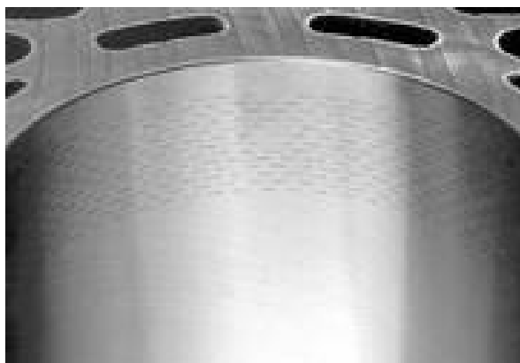
Rys. 3. Gładź cylindra po teksturoowaniu laserowym [7]
