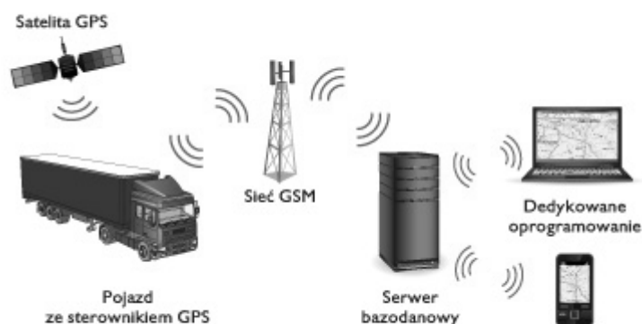
Rys. 4 Zasada pracy systemu satelitarnego
