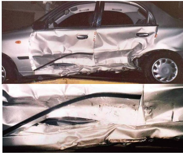
Рисунок 3,4. – Пошкодження бокової частини кузова автомобіля Daewoo Lanos, який на момент поперечного зіткнення був нерухомим
