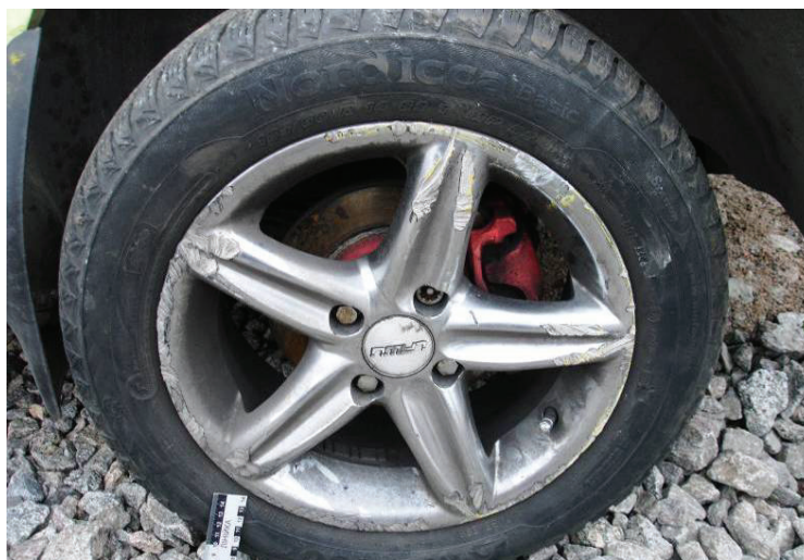
Рисунок 2. – Пошкодження диску та шини переднього правого колеса автомобіля Skoda Felicia, який на момент перехресного зіткнення рухався
