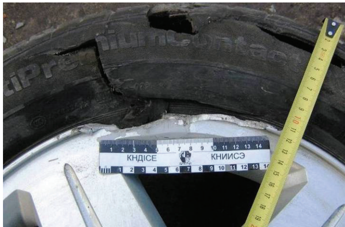
Рисунок 5. – Пошкодження диску та шини заднього лівого колеса легкового АТЗ, що свідчать про його нерухомий стан на момент попутного наїзду
