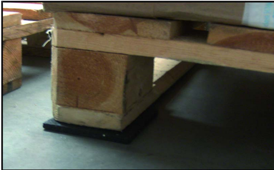
Rys. 7. Przykład maty antypoślizgowej pod europaletą [3]
