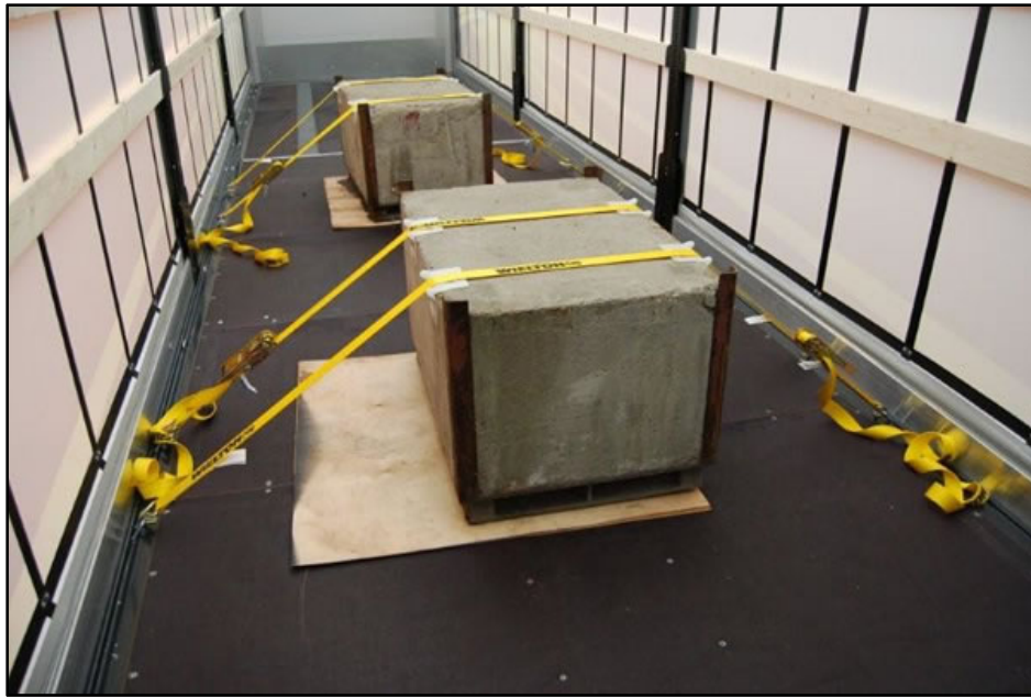
Rys. 6. Przykład mocowania z użyciem napinacza zapadkowego [3]
