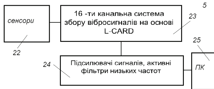
Рисунок 3. – Блок-схема вібровимірювального комплексу
