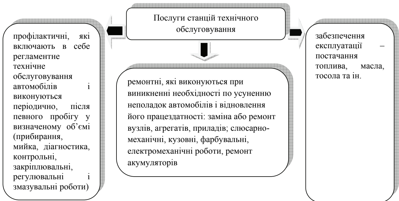
Рисунок 1 – Схема поділу послуг станцій технічного обслуговування
