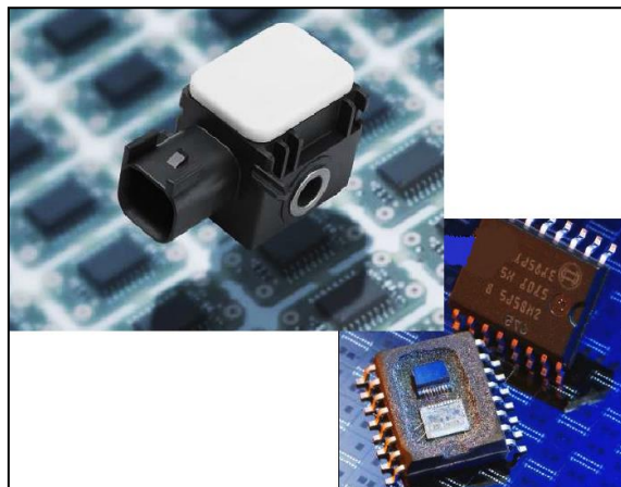
Rys.4. Przykładowe powierzchniowe czujniki wyzwalania poduszek powietrznych [8]
