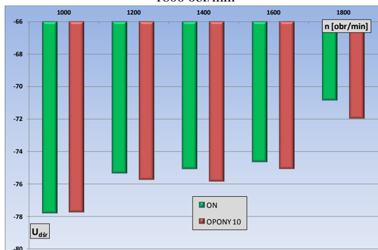
Rys. 10. Porównanie widma sygnału akustycznego zmierzonego podczas pracy silnika badawczego na oleju napędowym ON oraz paliwie OPONY 10 przy prędkości obrotowej wału korbowego silnika n = 1800 obr/min
