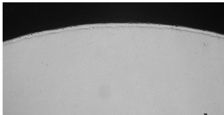
Рисунок 5 – Мікроструктура карбоборованої сталі 10 (нетравленого шліфа), x50
