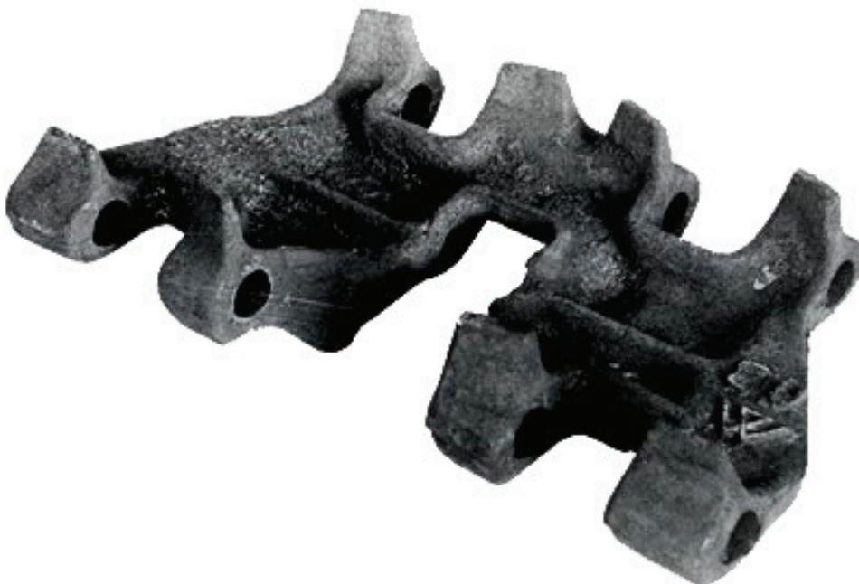
Рисунок 1 – Трак гусеничних машин (сталь 110Г13Л)
