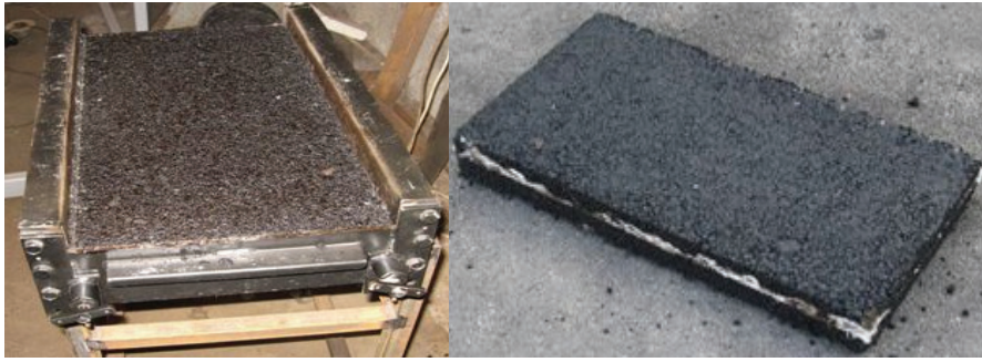
Рисунок 5 – Плита армованого асфальтобетону після виготовлення
