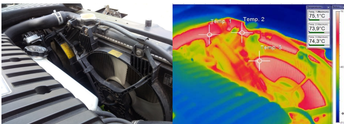
Rys. 3. Obraz rzeczywisty i termogram rozkładu temperatury układu chłodzenia silnika samochodu Mitsubishi Galant
