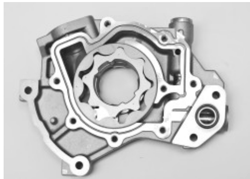
Rys. 2. Pompa olejowa o zazębieniu wewnętrznym [9]
