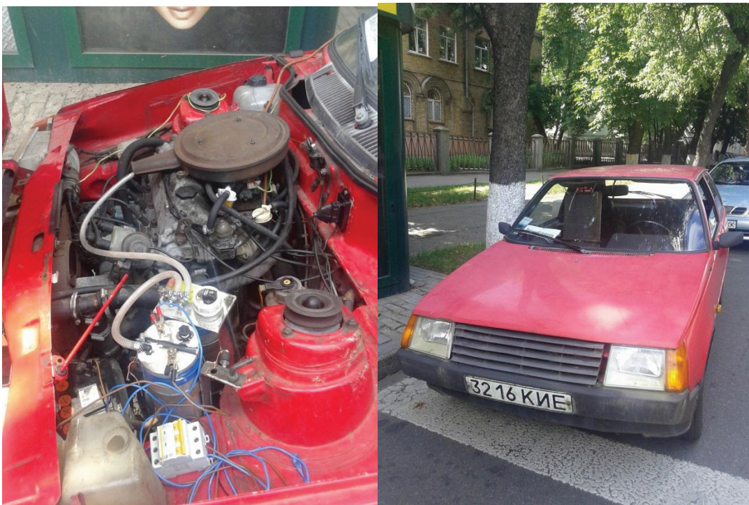
Рисунок 1 – Експериментальна установка на базі автомобіля ЗАЗ-1102 «Таврія» під час випробувань на маршрутах по місту Києву
