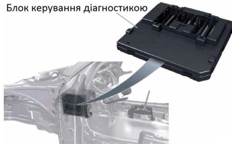
Рисунок 2 – Блок для запуску самодіагностики.
