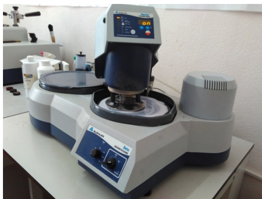
Рисунок 3 – Установка для отримання металографічних шліфів Figure 3 – Machine for obtaining metallographic grinding specimens
