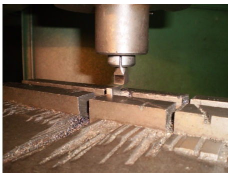
Рисунок 2 – Процес вільного прямокутного різання
