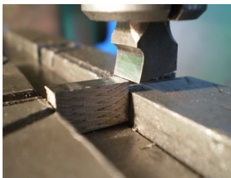
Рисунок 2 – Процес вільного прямокутного різання
