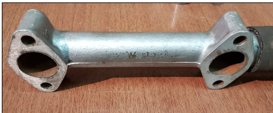
Rysunek 3 – Jeden z dwóch oryginalnych kolektorów układu chłodzenia
