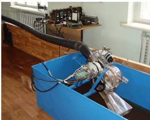
Рис. 6. Лабораторна модельна установка з роторно-лопатевою турбіною
