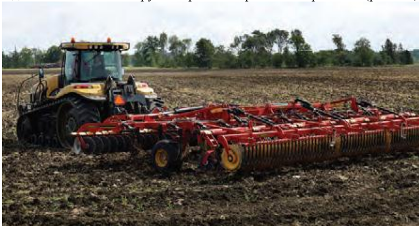
Рис. 4. Комбінований ґрунтообробний агрегат TopDown
