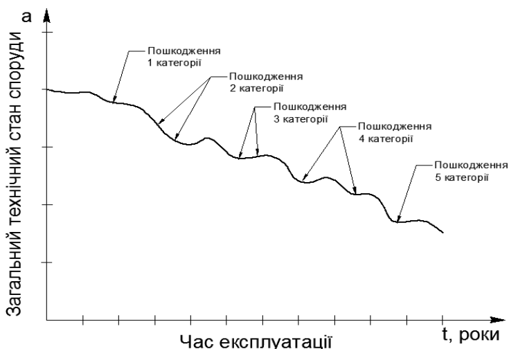
Рис. 1. Зміна надійності споруди в процесі експлуатації
