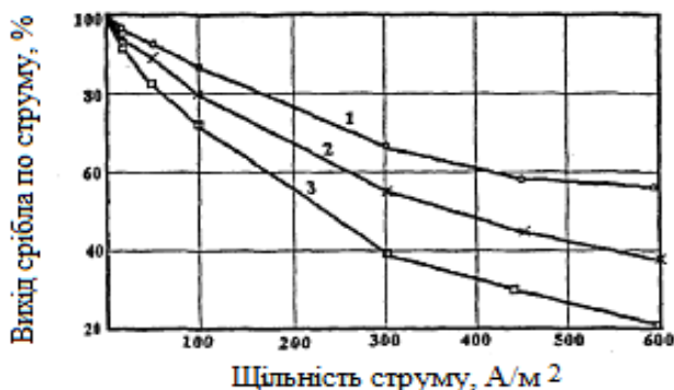
Рис. 7. Залежність виходу іонів срібла по струму від анодної щільності струму при різному вмісті срібла в аноді: 1 – проба 999,9; 2 – проба 875; 3 – проба 800
