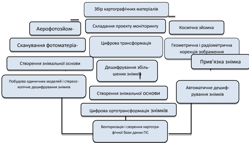
Рис. 2. Технологія моніторингу територій за матеріалами аеро-і космічних зйомок [9]
