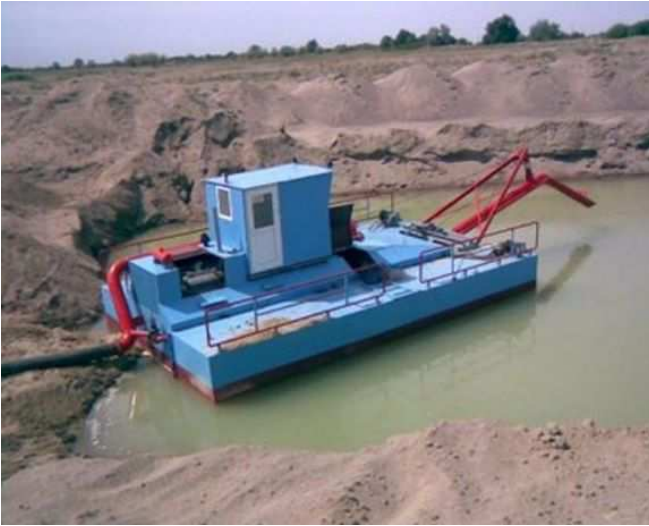
Рис. 2. Добування бурштину з розробкою родовищ земснарядми або з використанням гідромоніторів
