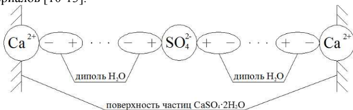
Рис. 4. Схема электрогомогенного взаимодействия между частицами CaSO_4 \cdot 2H_2O
