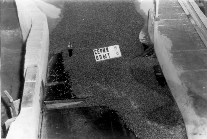
Рис. 1. Картина наносних відкладень біля бокової перешкоди уловлювача піску та гравію
