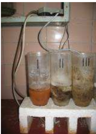
Рис. 1. Лабораторна установка для очищення стічних вод, що містять ГМД
