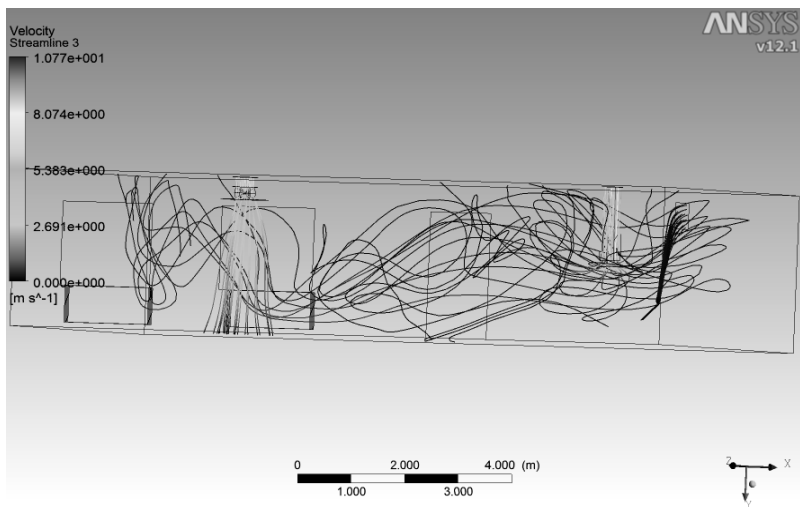
Рис. 3. Розподіл повітряних потоків у приміщенні при подачі повітря повітро-розподільником із кутом нахилу закручуючих пластин 60°
