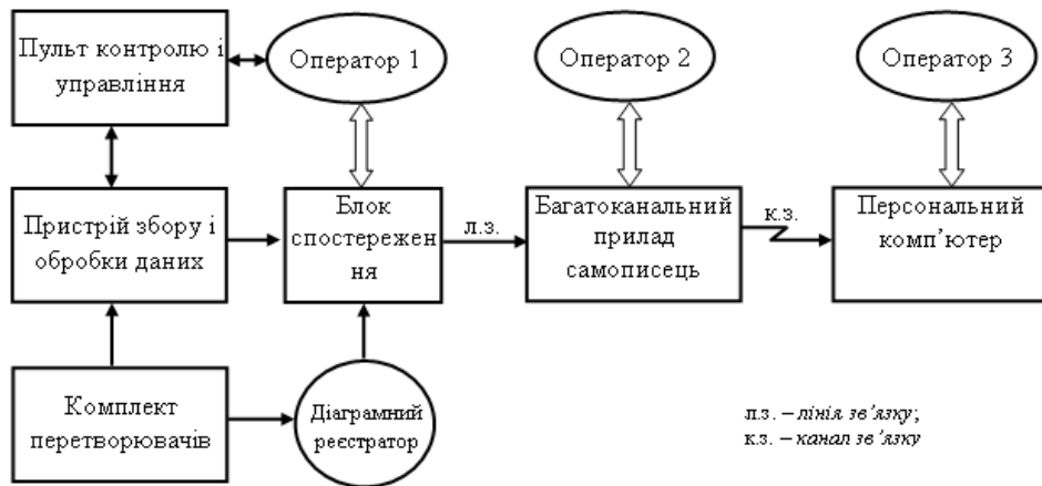
Рис. 1. Структура аналогової розподіленої інтерактивної системи контролю і управління бурінням СКУБ-М
