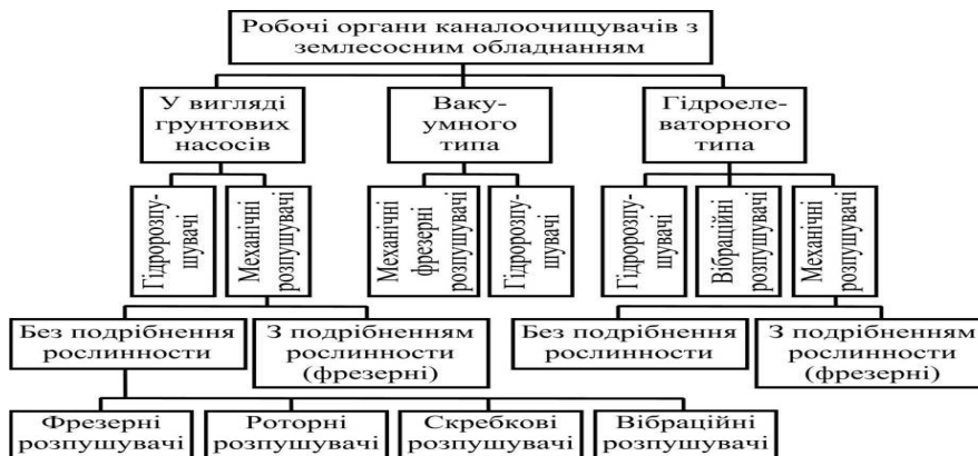
Рис. 1. Класифікація робочих органів для очищення каналів
