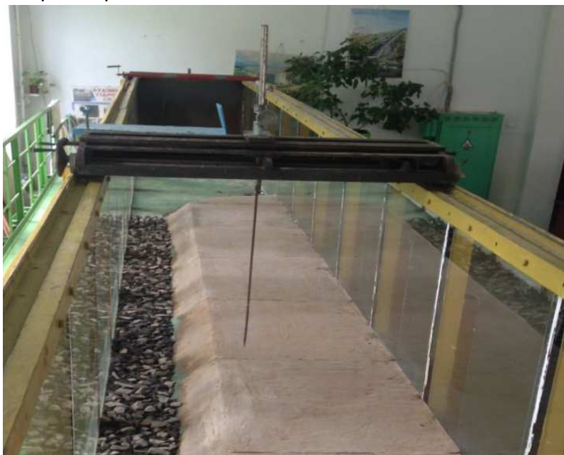
Рис. 3. Вид лотка та тастера, закріпленого на рухомій каретці
