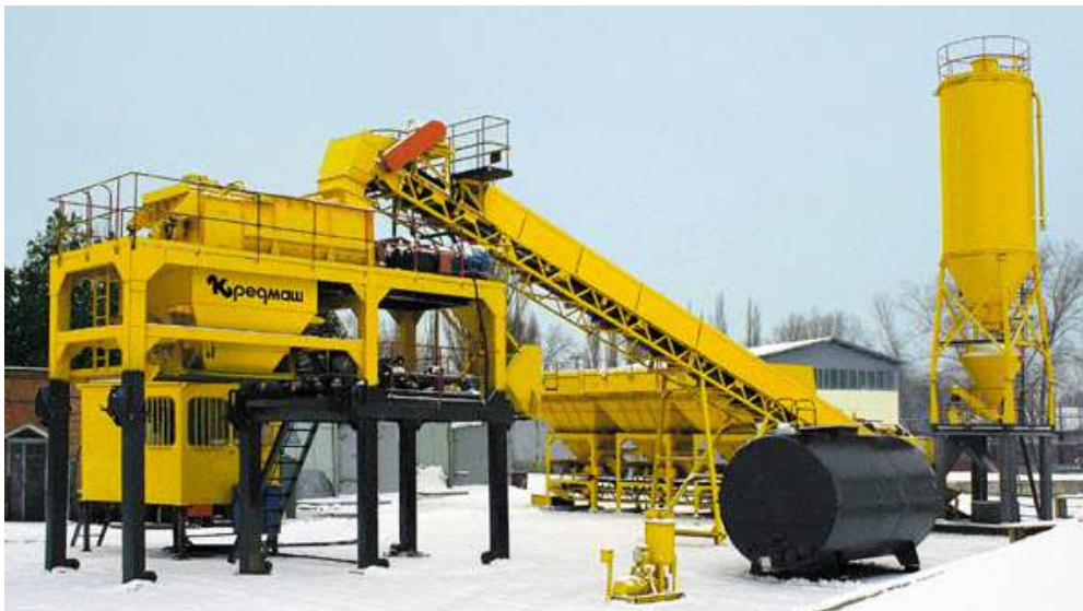
Рис. 9. Ґрунтозмішувальна установка для приготування ґрунтосуміші
