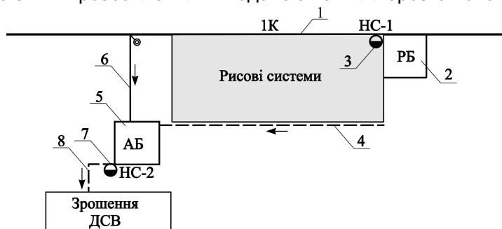
б) водообігова система з механічним водопідйомом ДСВ та з їхнім розбавленням і подачею на нижчерозташовані землі
